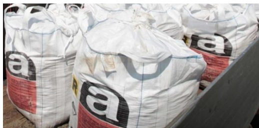
Fig. 3- Rifiuti contenenti amianto confezionati in big-bag.
