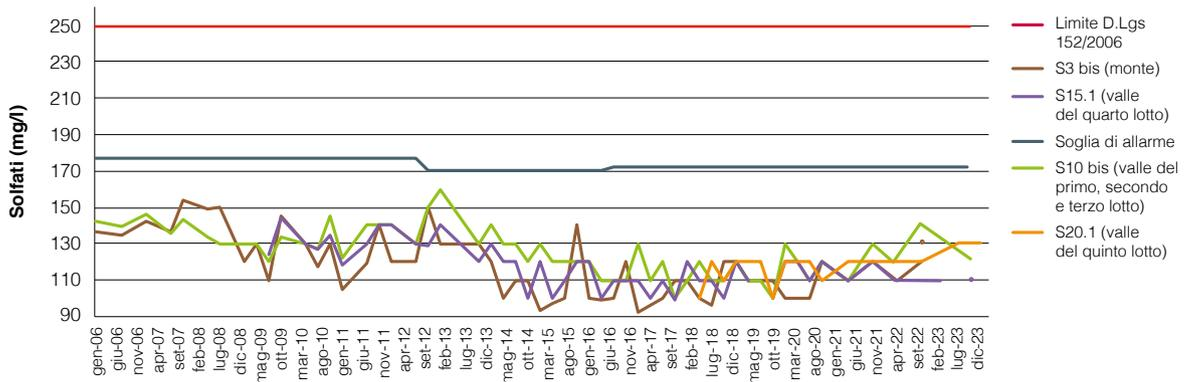
Le soglie di allarme indicate nei grafici sono più basse dei limiti di legge, ad esempio per i solfati la soglia di allarme è stata fissata a 172 mg/l a fronte di un limite di Legge di 250 mg/l. Per la conducibilità non vi sono limiti di Legge, ma è un parametro tenuto sotto controllo in quanto indicativo, in modo semplice, di eventuali contaminazioni.
