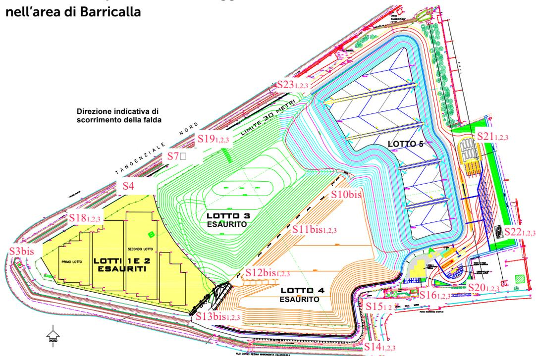
In ogni punto di monitoraggio sono collocati tre piezometri, ossia tre pozzi che indagano la qualità delle acque a tre profondità differenti della falda (fra i 30 m ed i 50 m), in modo tale da poter avere informazioni circa il suo stato su tutto lo spessore della falda.
