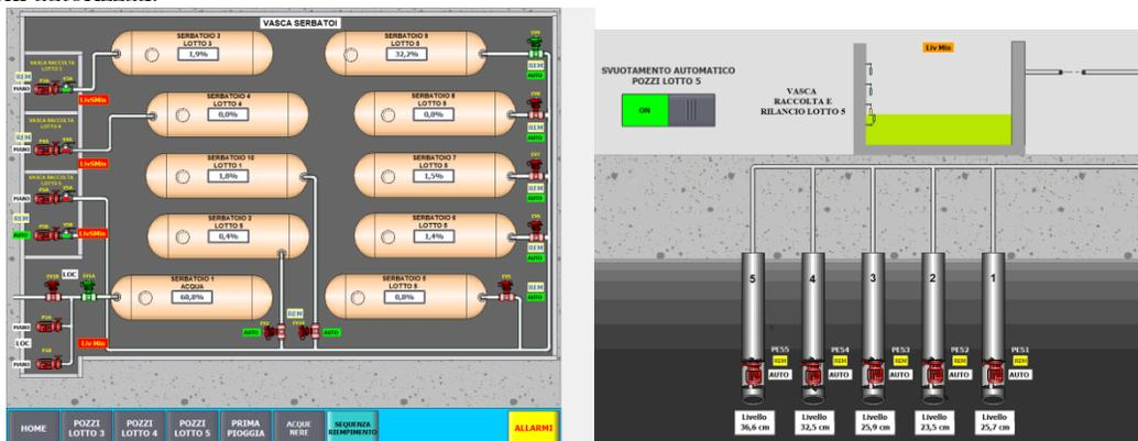
Fig. 6- Sistema di controllo per l'estrazione del percolato.
