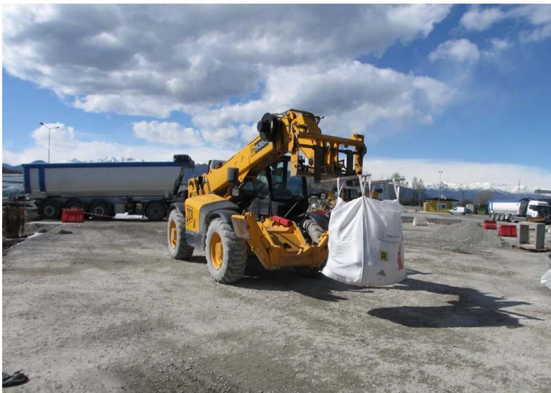
**Fig. 5 - Movimentazione di big-bags da parte di macchine di movimento terra opportunamente attrezzate.**
