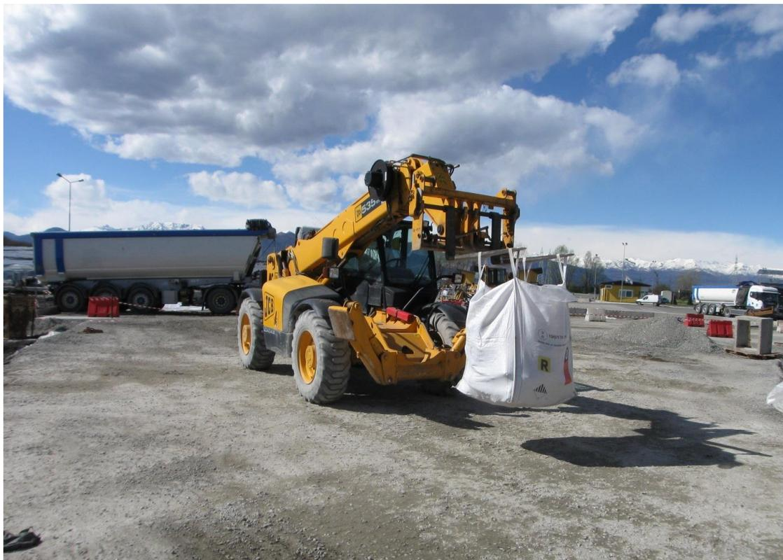
**Fig. 5 - Movimentazione di big-bags con gru semovente.**
