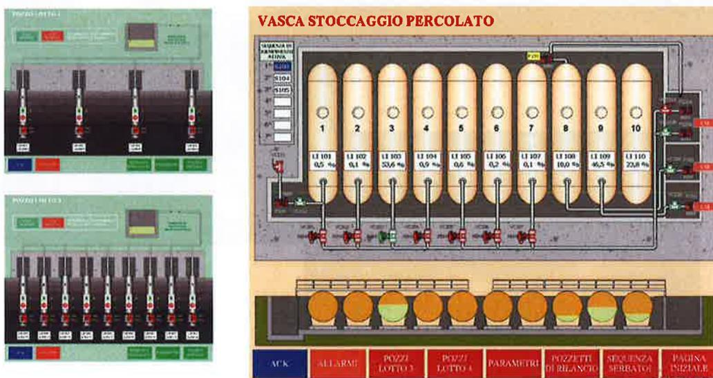
Fig. 6- Sistema di controllo per l'estrazione del percolato.
