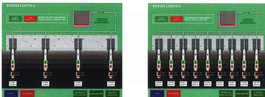
Fig. 6- Sistema di controllo per l'estrazione del percolato.
