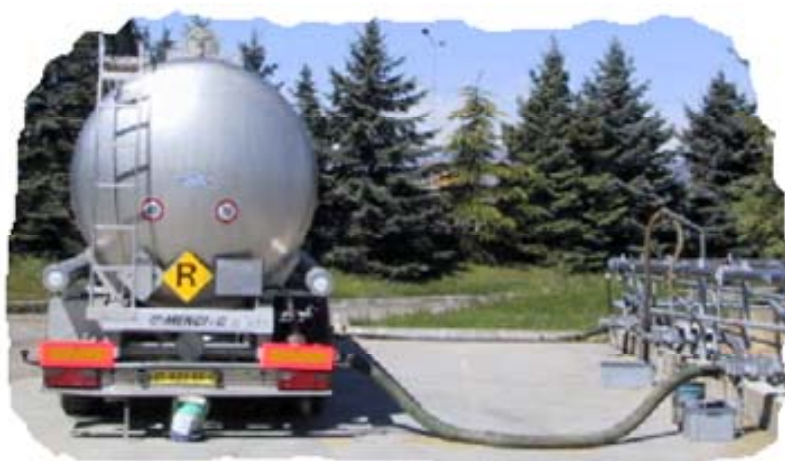
Figura 6 - Carico cisterna percolato
